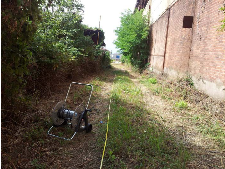
Stendimento sismico tomografico SS1 "p", estremo finale (G24)
