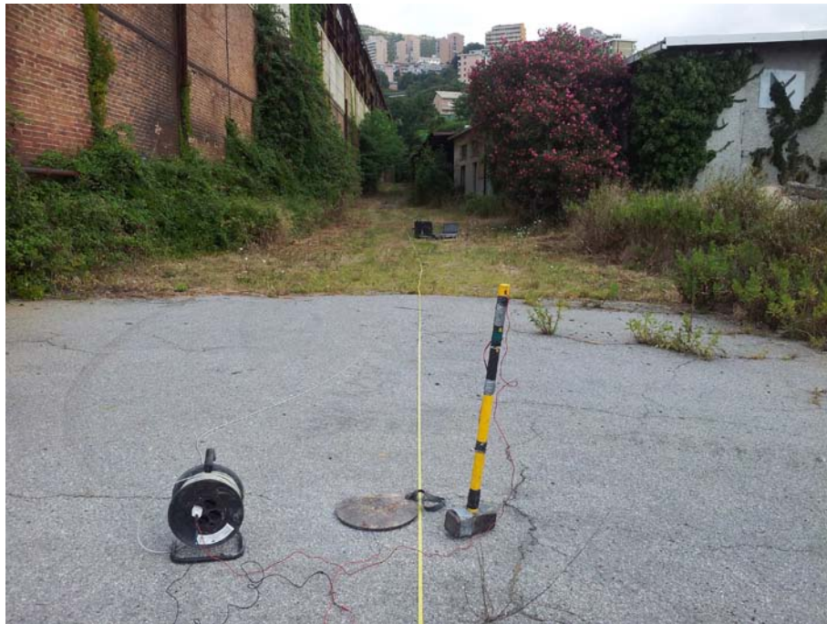
Stendimento sismico tomografico SS1 "p", estremo iniziale (G1)
