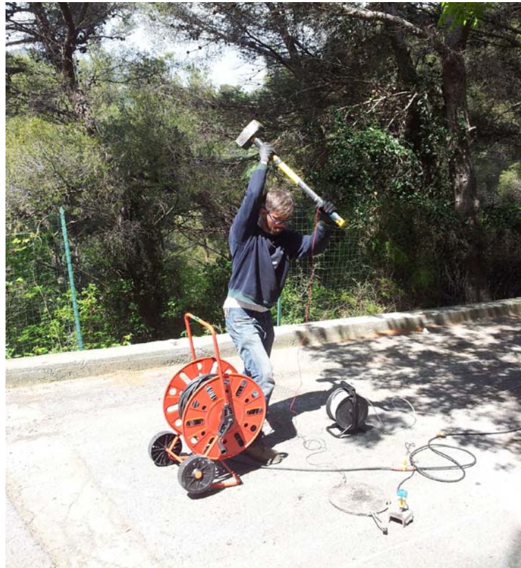
Esempio di procedura di energizzazione per generazione onde "p"
