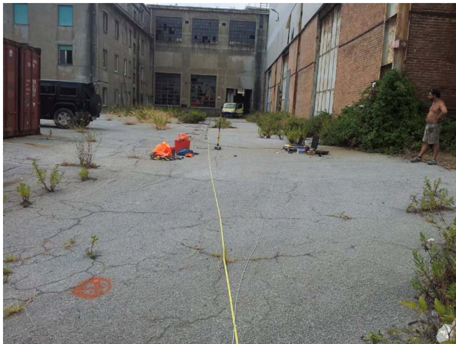
Stendimento sismico tomografico SS2 "p", estremo finale (G24)
