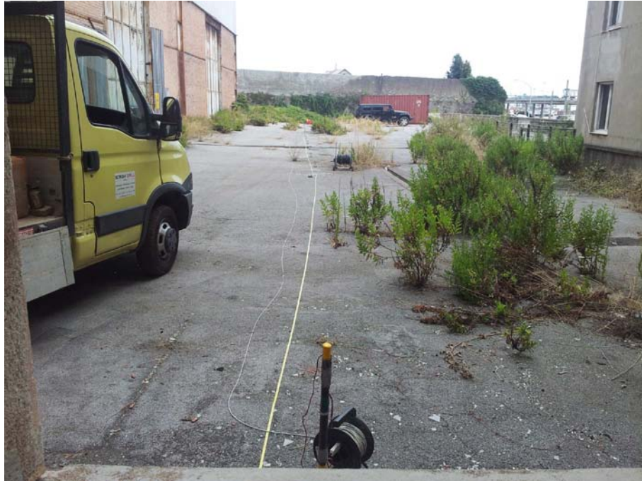
Stendimento sismico tomografico SS2 "p", estremo iniziale (G1)
